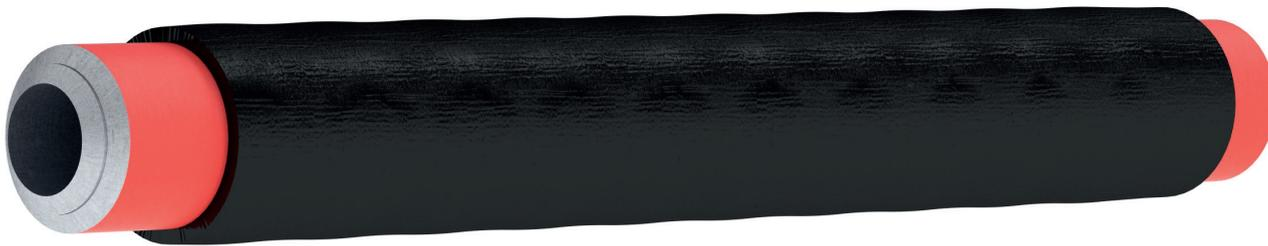
Металлопластмассовые трубы и патрубки диаметром до 325 мм с максимальной толщиной стенки 20 мм представляют собой стальную трубу, патрубок с наружным полиэтиленовым (для подземной прокладки) или лакокрасочным покрытием (надземная прокладка), футерованные внутри полиэтиленовой трубой (оболочкой) и закрепленные наконечниками из:
